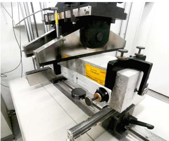
Die Durchbiegung des Prüfbalkens wird durch Wegaufnehmer gemessen. Die Kraft und die zugehörige Durchbiegung werden als Last-Durchbiegungs-Kurven zur Bestimmung der Leistungsklassen abgebildet.
